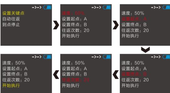
5. 延时拍摄: 延时拍摄设置-设置好所需参数-开始执行
