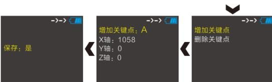
B: 视频拍摄-自动模式-设置关键点-增加关键点B(操作轨道移动到想要的任意起点)-确定保存
