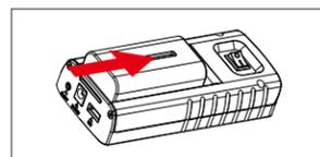
控制器安装电池示意图
