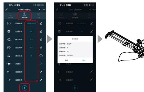
当设置好延时拍摄参数并开始启动拍摄后, 手机连接可以离开或断开, 延时拍摄期间不需要手机控制。滑轨会自动完成拍摄设定的张数并停止。
